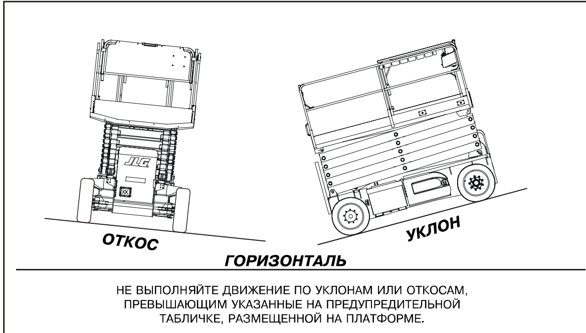
Рисунок 4-1. Уклон и откос
